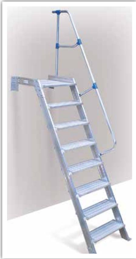
L'escalier technique 60° VECTAWAY® est disponible en 8 modèles de 3 à 12 marches. C'est un escalier économique qui présente l'intérêt d'avoir un encombrement au sol réduit. Il est destiné à être utilisé pour des fréquences d'utilisation faibles. Dans le cas d'utilisation plus soutenue, il est préférable d'utiliser les escaliers techniques à 48°.
