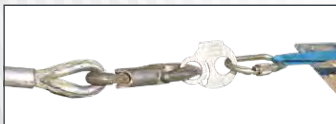
UTILISATION D'UNE PLAQUETTE DE RUPTURE
