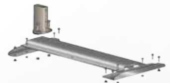
Embase onde 333 mm pour garde-corps bac acier perpendiculaire au bac Ensemble livré monté - Fixation au bac par 6 vis Drillnox DBS2 + rondelles cheminées
