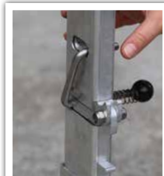
4. Enclencher la manette dans le logement en relâchant la poignée (le logement est muni de crans de verrouillage), afin de verrouiller complètement le montant, puis pousser la manette côté extérieur jusqu'au dernier cran. Le système est alors entièrement verrouillé.
