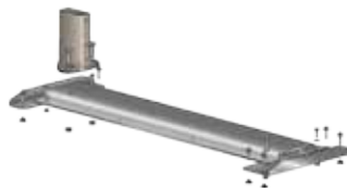
Embase onde 250 mm pour garde-corps bac acier perpendiculaire au bac Ensemble livré monté - Fixation au bac par 6 vis Drillnox DBS2 + rondelles cheminées
